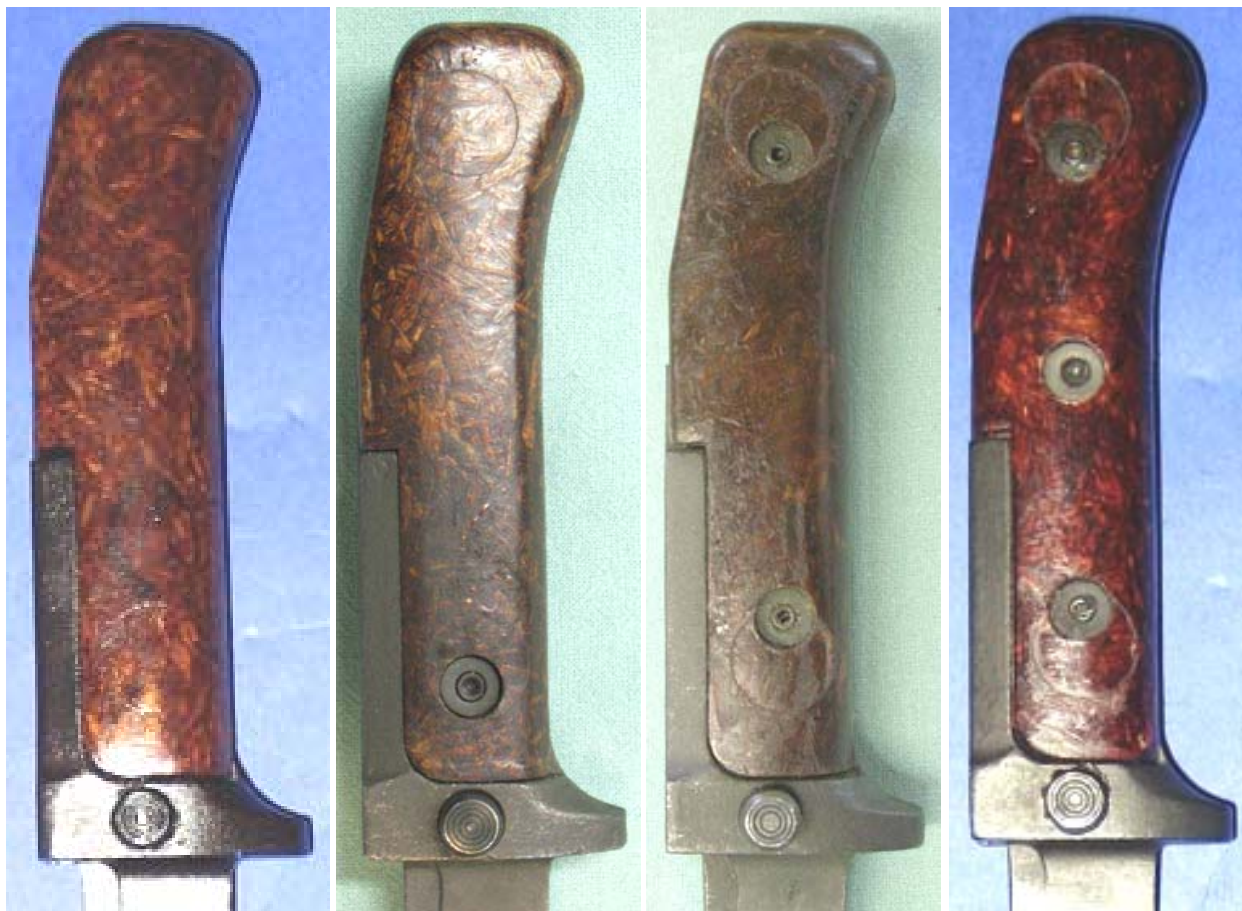
Třetí typ bodáku s různým počtem nýtů
