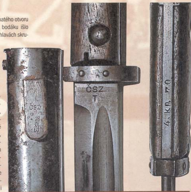
ÚPRAVA BODÁKU, ODSTRÁNENIE KRÚŽKU, OTOČENÉ ÚSTIE POŠVY ZAISTENÉ SKRUTKOU, MODRENÝ, NA RAPE OZNAČENIE PRIDELENIA V NEMECKEJ JEDNOTKE - „4. KOMPANIE/70“
